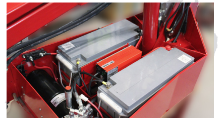
2 12V 160 Ah Batterien sorgen für 9 Std Autonomie
