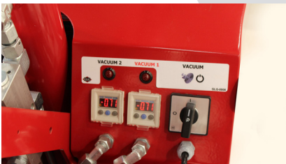
2 getrennt Vakuumsysteme mit je 200% Kapazität.
