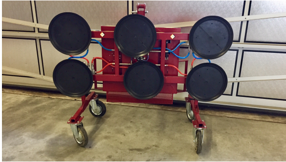
500 kg Hubkraft mit 6 Saugteller Gewicht 114 kg
